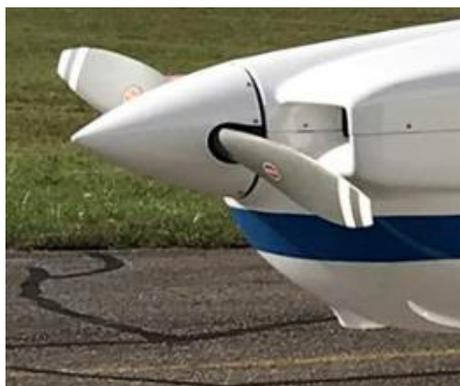
Ce nouveau cône d'avions TB est entièrement réalisé en matériaux composites (fibre de carbone principalement combiné à de la fibre de verre) et est revêtu en standard d'un gelcoat blanc en surface.
