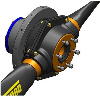
À ce stade, l'hélice est installée selon votre montage sur l'avion avec sa platine de cône.
