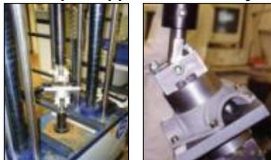
Pour ces deux cas, les résultats en termes de rigidité et charges apparentes de rupture sont exploités. La capacité des cellules de charge étant limitée, l'essai ne pourra atteindre la rupture de la pièce dans la plupart des cas. En outre, la rupture des vis de fixation des pièces sur l'outillage durant les essais se sont plusieurs fois produites.
