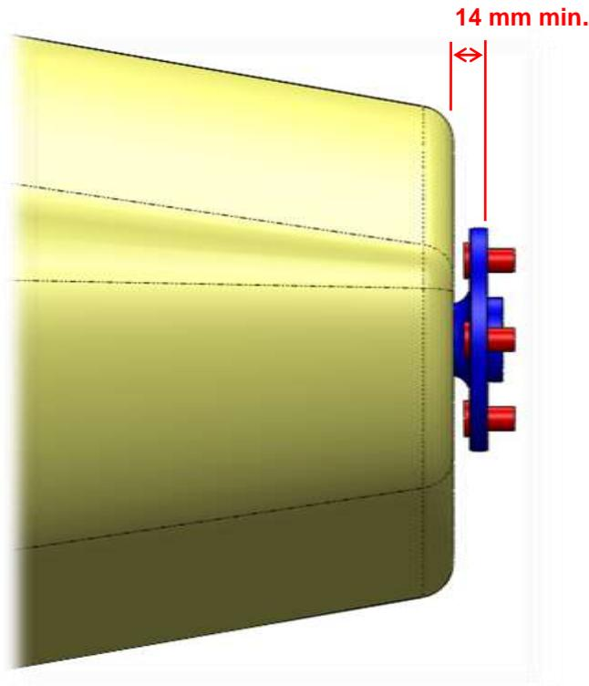
*\* si présence de 6 trous lisses Ø8mm sur Ø75mm (Type porte-hélice moteur ROTAX 912)*
